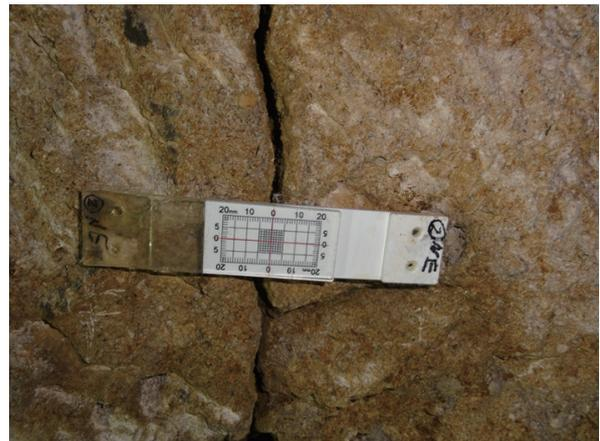
図8 亀裂計測計（製品名：Avongard Tell-Tale）
